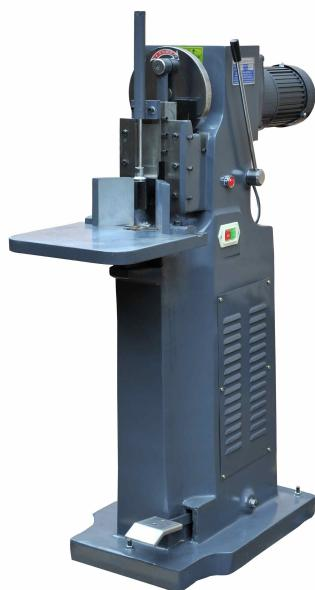
SWY-25型索挖月机主要适用于各大生产笔记本、工作手册的纸品厂，是高级笔记本、工作手册等具有检索功能的特殊形状角挖切的必需设备□SWY-25 型索引挖月机设计合理、操作方便性能稳定，能提高产品档次，还可根据各种纸品的冲切需要，换用各种形状和规格的刀具。温州市旭
